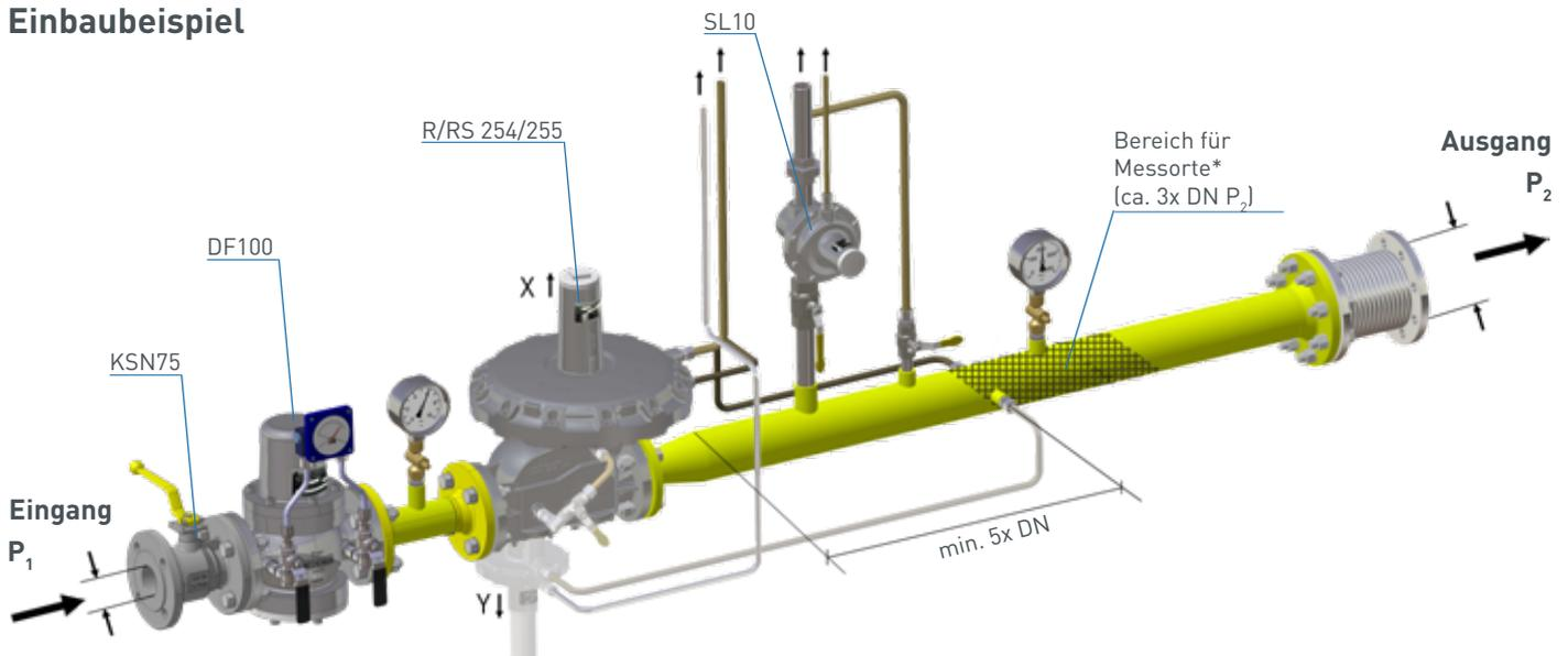
\*) Empfohlene Gasgeschwindigkeit am Messleitungsanschluss max. 25 m/s
